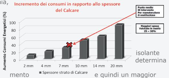
Uno strato calcareo di **soli 2 mm** di spessore, riduce la trasmissione del calore in uno scambiatore di calore a tubi piatti del **90%** e il **rendimento di circa il 60%**.
